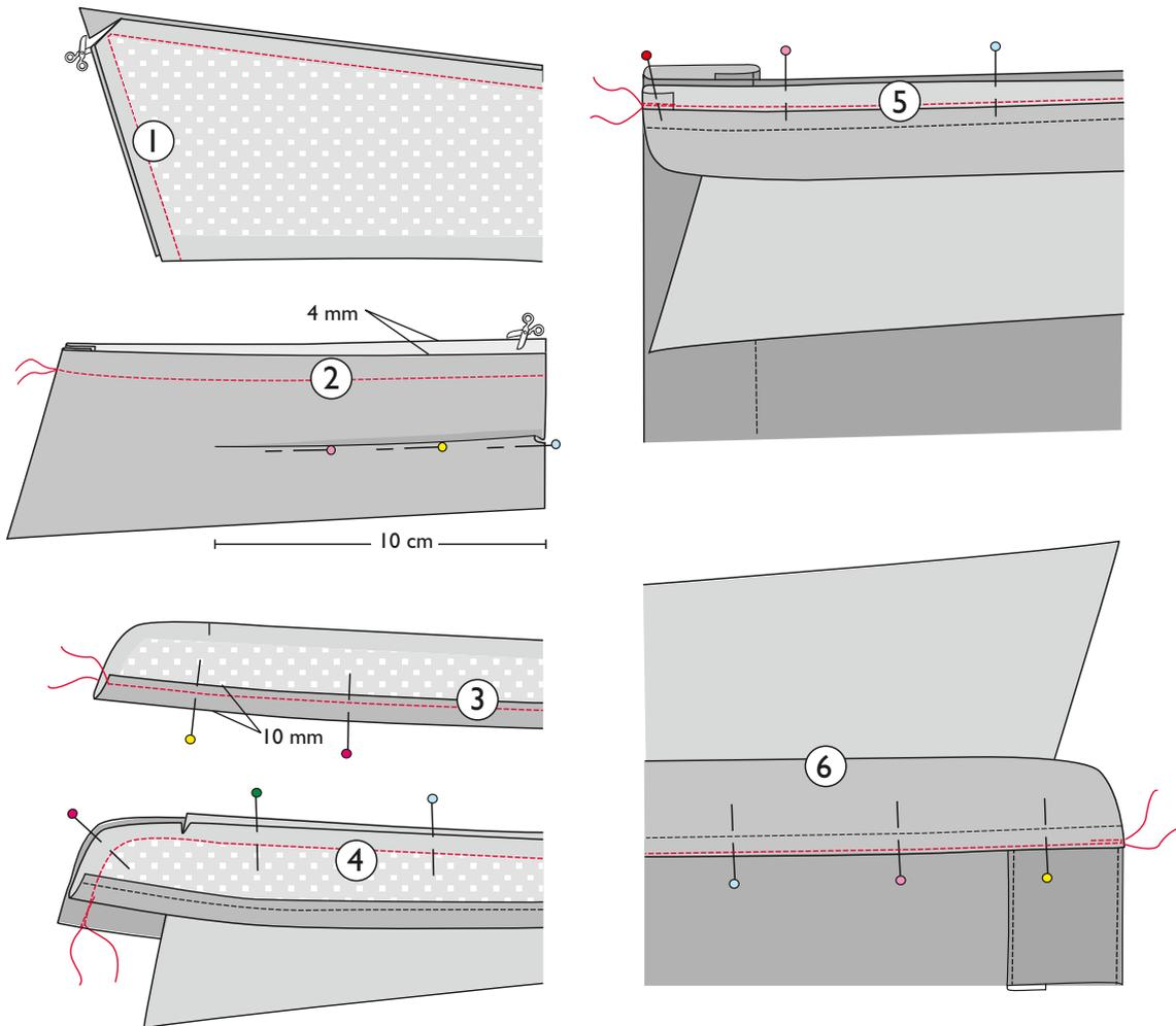
**1.** Encarar los derechos de las piezas del cuello y coser los extremos y el borde exterior. Recortar las esquinas en diagonal, abrir las costuras con la plancha y volver el cuello del derecho.
