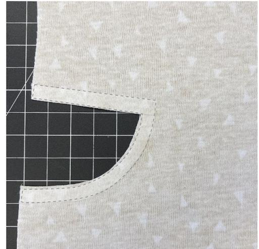
Schmalen Einlagenstreifen für Nahtzugabe der Tascheneingriffkante des Vorderteils (Modell 14) oder vord. Hosenteils (Modellen 1 und 4) schneiden und aufbügeln.
